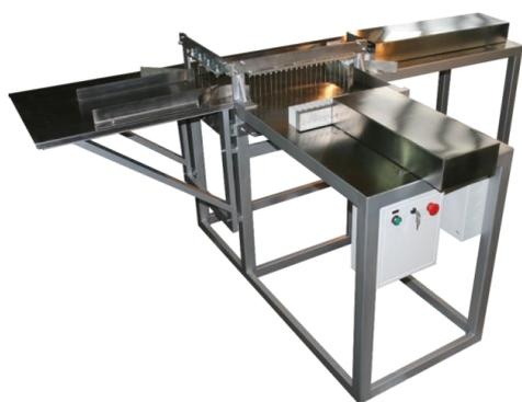
**Машина резки кондитерских пластов MP-2** - оборудование для струнной резки кондитерских пластов:
